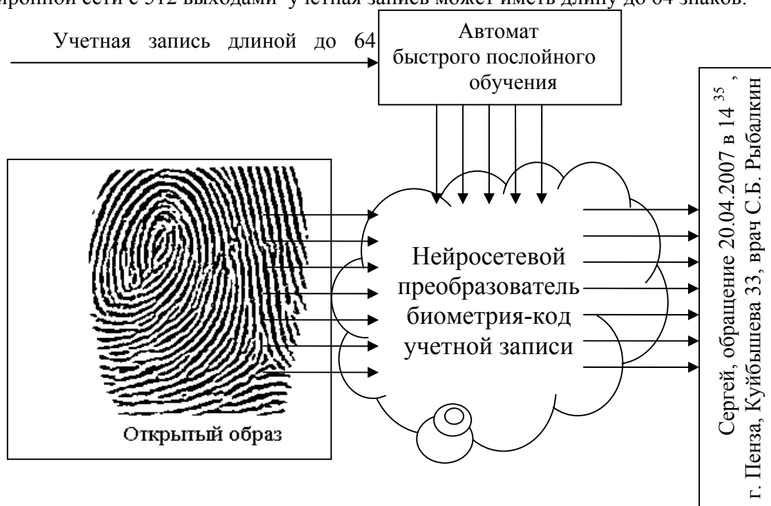
Рис. 1. Анонимная биометрическая идентификация больного с сокрытием его биометрического образа в параметрах нейросетевого преобразователя
